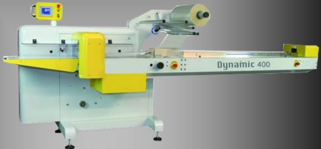
L'ensacheuse horizontale DYNAMIC 400 est une machine à commande électronique spécialement conçue pour offrir des performances élevées avec des temps de changements de série réduits. Son interface tactile permet la sauvegarde de produits mémoires grâce à un cheminement graphique simple et intuitif.
