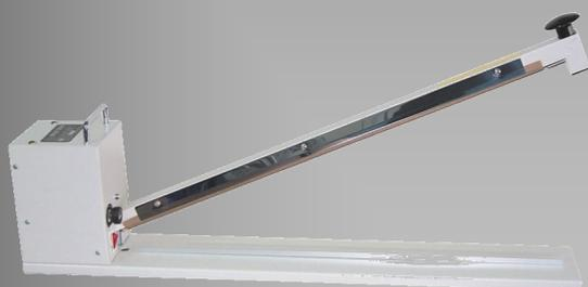
Soudeuse Manuelle à Impulsion pour la fermeture de sachets de grande largeur en Polyéthylène, Polypropylène ou autres Films Thermo-soudants. Temps de soudure réglable à l'aide d'un Potentiomètre en fonction du matériau à souder.
